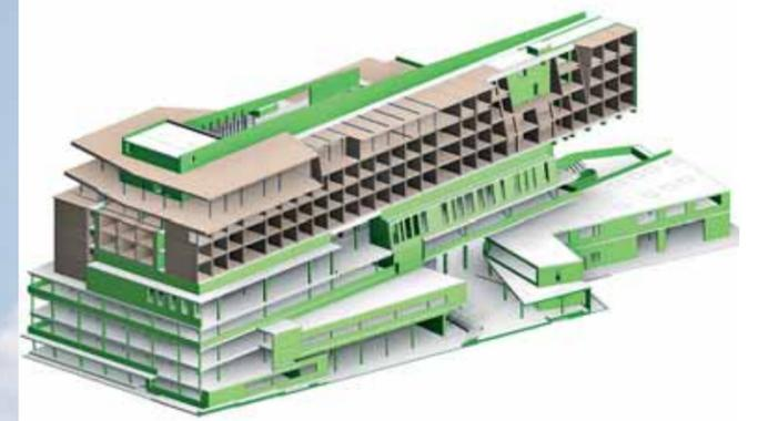
Besonderheit des Bauentwurfs ist die Kombination aus verschiedenen statischen Elementen. Einer der wesentlichen Baustoffe, der ab dem vierten Obergeschoss eingesetzt wird, ist Holz. Grafiken: RWT plus ZT GmbH (2)
